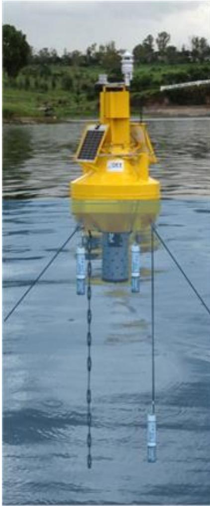
Figura 8. Hidro-boya HC marca Tech, para medición directa de parámetros ambientales (Tomada de <http://www.igs-hydro.mx/index.php/productos/sistemas/boya>).
